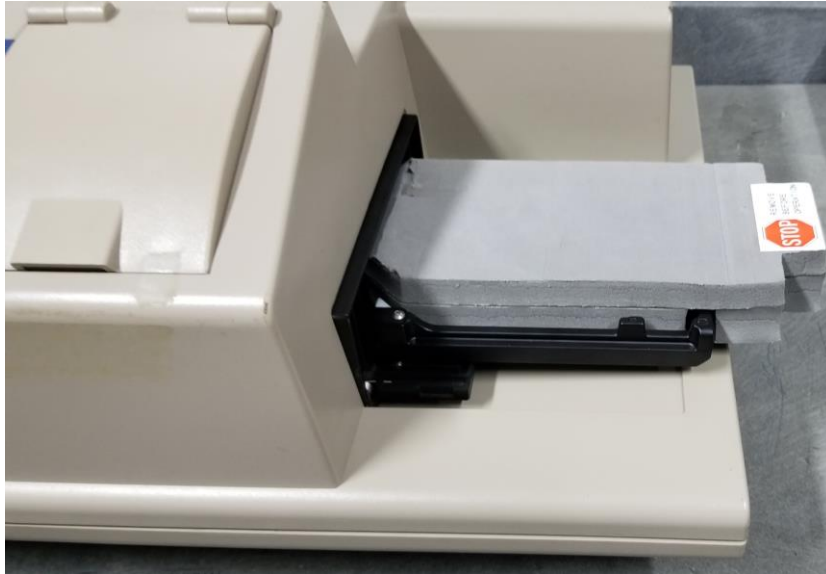
Figura 3: Espuma de travamento posicionada sobre a bandeja de amostra aberta.
